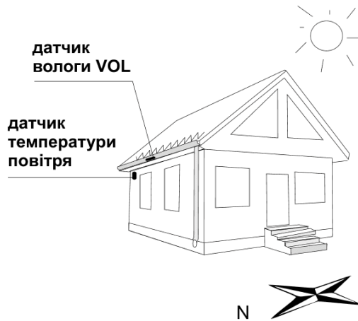
Рисунок 1. Розміщення датчика температури повітря та датчика вологості
